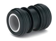
Plug & Seal 密封管接头是一种附着有橡胶层的管路模块,可以在热管理系统的各元件之间建立安全、无泄漏的连接,并实现热源和散热部件之间的有效热传递。密封管接头是一种安全、低成本的流体运输解决方案,适用于水、乙二醇和油等工程流体。管接头可以在单个部件中集成多种功能,并补偿管道偏心和公差变化。
